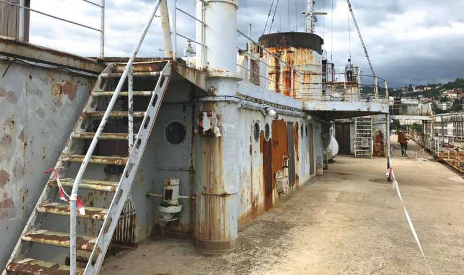
▲ La plancia della Galeb con il fondo realizzato niente po' po' di meno che in cemento armato. A destra la cabina di comando e il telegrafo della sala macchine
